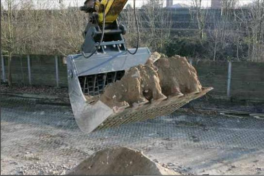
Mit der **"DASIE"-Siebschaufel** können Sie alle auf der Baustelle anfallenden Materialien wie Bauschutt, Baumischabfälle, Erdmassen, Schlacken oder Müllverbrennungsasche sinnvoll trennen und wiederverwenden. Sie gewinnen Lagervolumen, sparen so Transport- und Deponiekosten.
